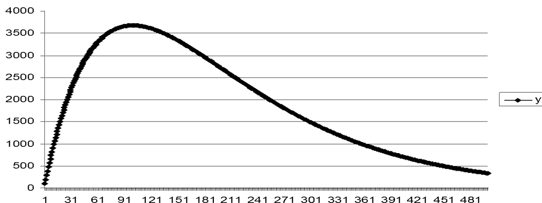
Рис. 4.4. График функции y = 100 * x * e^{-0,01x} . Условие 1 ( a=100 , b=0,01 )
