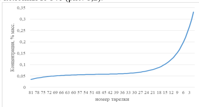
Рис. 1 График распределения концентрации изобутилена по высоте колонны.
