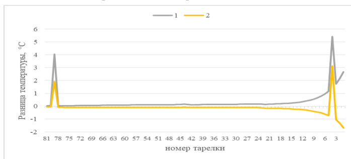
Рис. 4. Профиль градиента температуры на тарелке по высоте колонны: 1- при изменении состава питания на +2%, 2- при изменении состава питания на -2%
