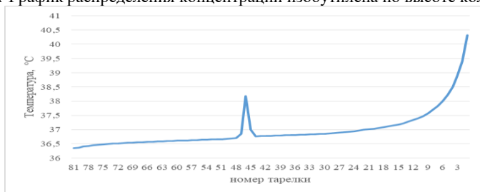
Рис. 2 Профиль температуры по высоте колонны.
