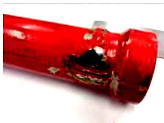
Рисунок 3 – Характерное место поломки крепления фиксатора
