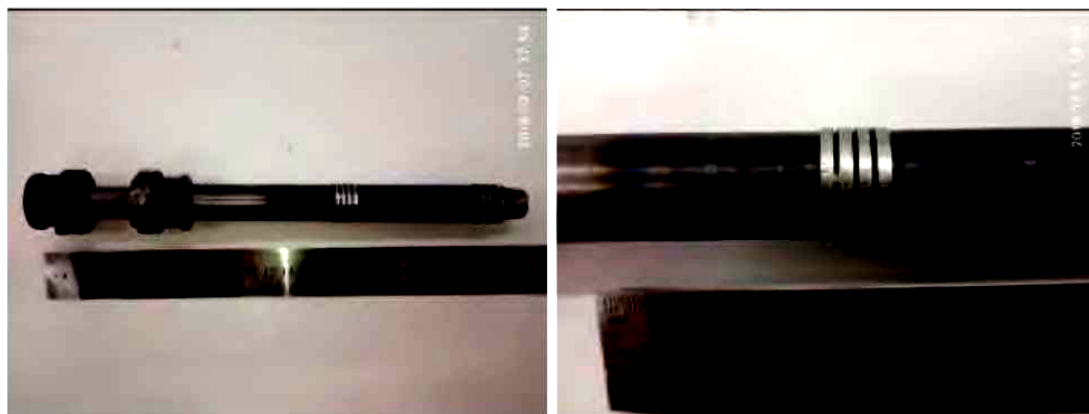
Рисунок 5 – Характерный износ сопрягаемой поверхности бойка
