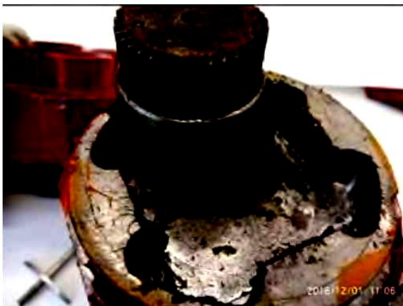
Рисунок 2 – Смятие зубчатого колеса отбойного молотка
