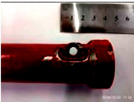
Рисунок 3 – Характерное место поломки крепления фиксатора
