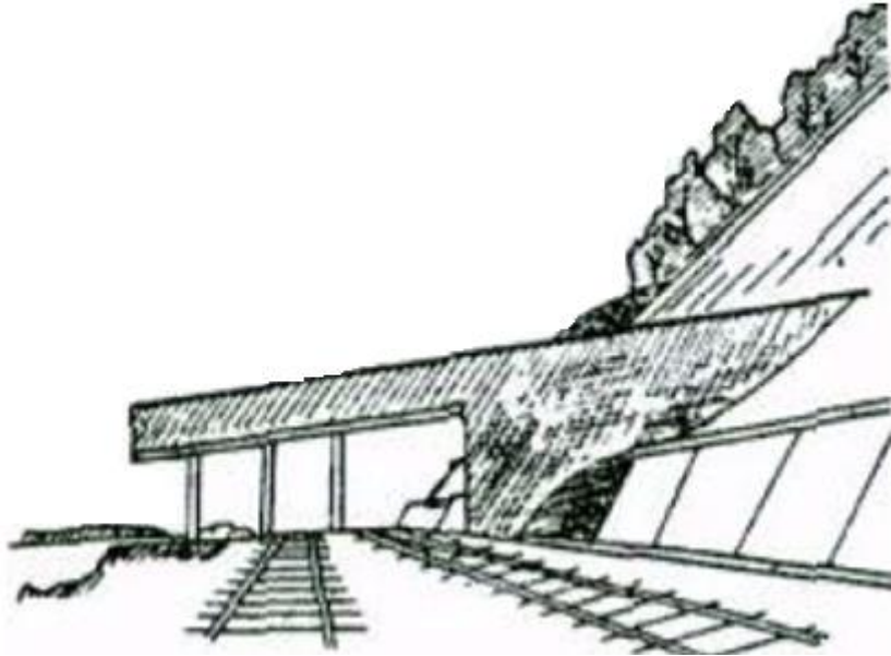
Рисунок 4.4 – Схема устройства селедука для сброса селя над железнодорожным полотном
