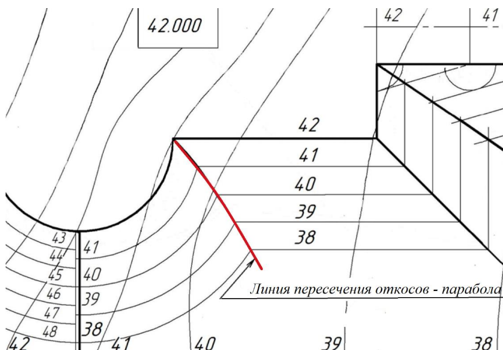
Рисунок 57 – Построение линии пересечения прямолинейного и криволинейного откосов
